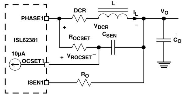
FIGURE 26. OVERCURRENT-SET CIRCUIT
