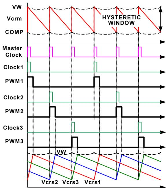
FIGURE 5. R3™ MODULATOR OPERATION PRINCIPLES IN STEADY STATE
