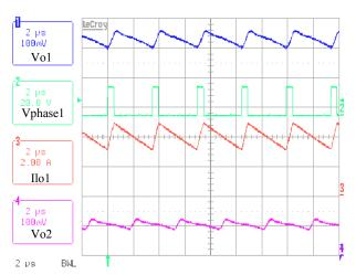
FIGURE 18. OPERATION AT HEAVY LOAD OF 4A, CHANNEL 1
