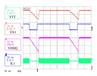
FIGURE 30. VTT FOLLOWS VDDQ, ENABLE 2 IS HIGH
