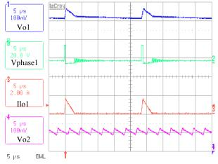
FIGURE 17. OPERATION AT LIGHT LOAD OF 100 MA, CHANNEL 1
