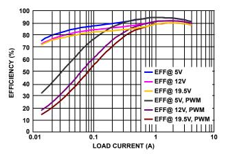
FIGURE 1. EFFICIENCY OF CHANNEL 1, 2.5V, HYS/PWM MODE
