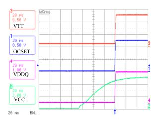
FIGURE 24.  $V_{CC}$  POWER UP IN DDR MODE
